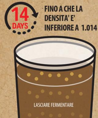
**f** Chiudere il coperchio e lasciare per 14 giorni nel fermentatore prima di imbottigliare. **SUGGERIMENTO:** la pazienza è la chiave! La fermentazione sarà completa quando la densità è inferiore a 1.014 e rimane stabile per 48 ore. A seconda della temperatura del mosto potrebbero volerci più di 14 giorni per raggiungere la densità ottimale.
